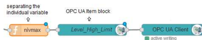
Fig. 2.1-2 Inserting tag values in the OPC UA server
