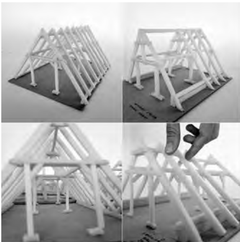
Figura 4.3.1.1. Machete deformabile pentru șarpante
