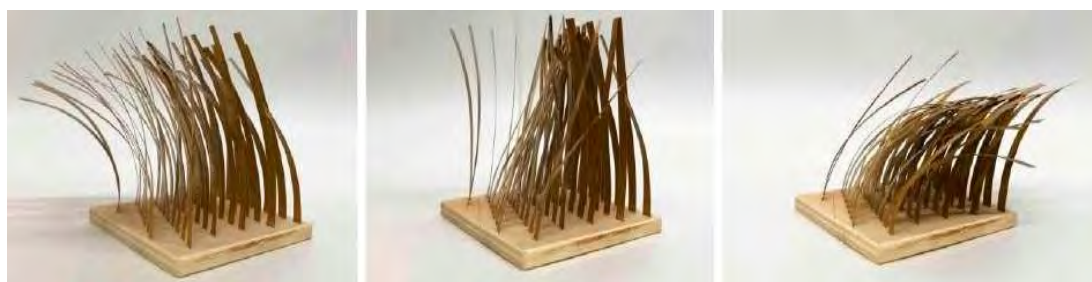
Figura 4.2.6.3. Compozit hârtie reciclată și folie Kapton - deformații între 18 grade C și 50 grade C.
