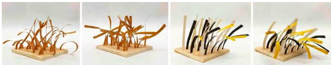
Figura 4.2.6.1. Diferite mostre cu modificări ale formei în funcție de temperatură
