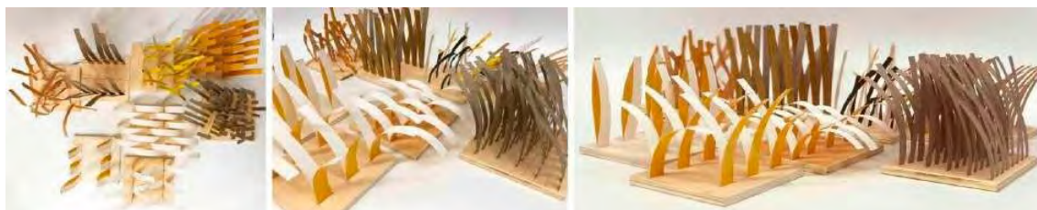
Figura 4.2.6.2. Compozite hârtie (Kraft, presată la cald) deformată permanent de diferențe de temperatură
