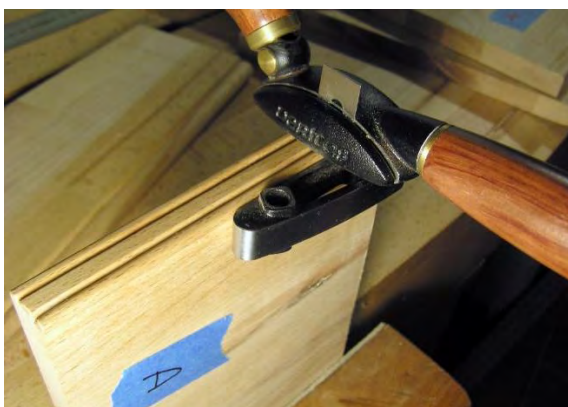
Figură 4.2.2.2 Realizarea manuală a profilului inițial D folosind o lamă profilată special pentru aplicație
