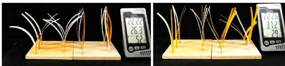
Figura 4.2.6.6. Compozit hârtie / folie Kapton, modificări în intervalul de temperatură, 18 °C - 50 °C —soluția dezvoltată în prototip
