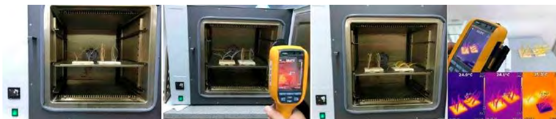
Figura 4.2.6.9. Compozit hârtie / folie Kapton, teste folosind camera cu termoviziune
