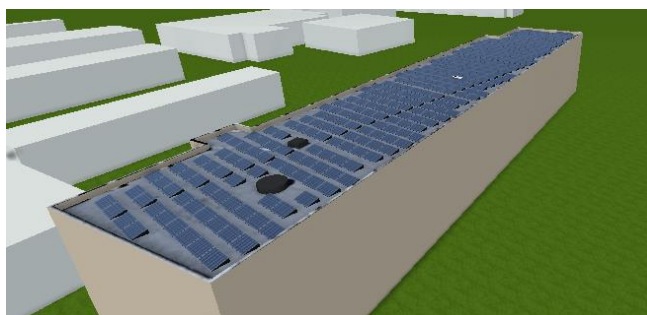
Fig. 34 Amplasare sistem PV - orientarea Sud [91]
