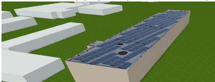
Fig. 31 Amplasare sistem PV - orientarea Est și Vest [18]
