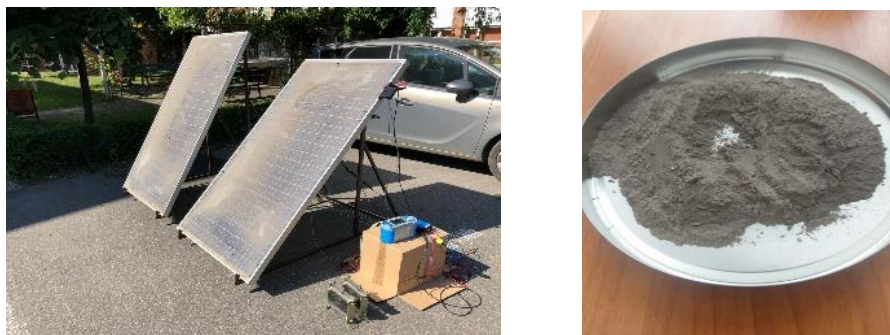
Fig. 6. Panouri policristaline testate încărcate cu praf [20]
